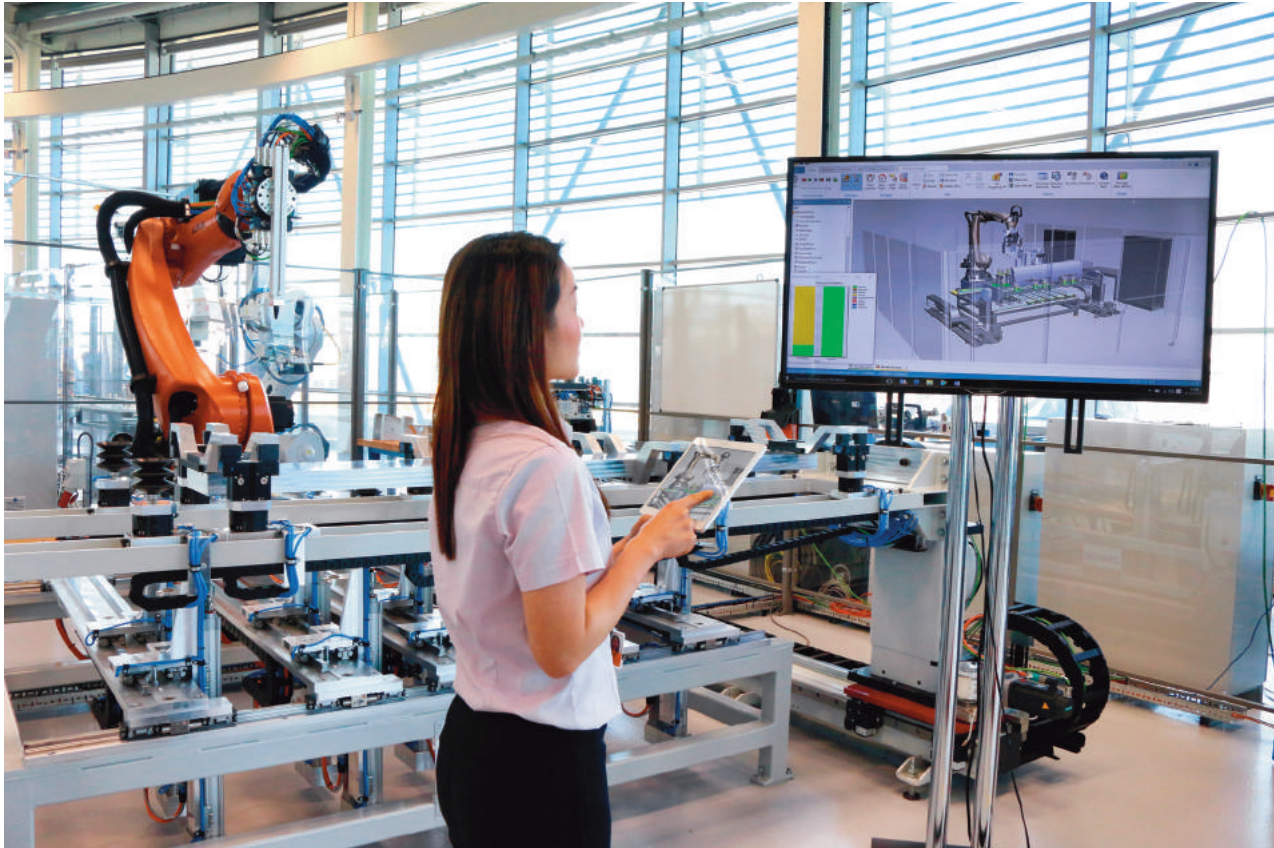
Teknisk assistent og leder for produksjonsintelligens oppretter en digital tvilling i University of Sheffield's produksjonstekniske forskningscenter. Foto: The University Of Sheffield Advanced Manufacturing Research Centre.
